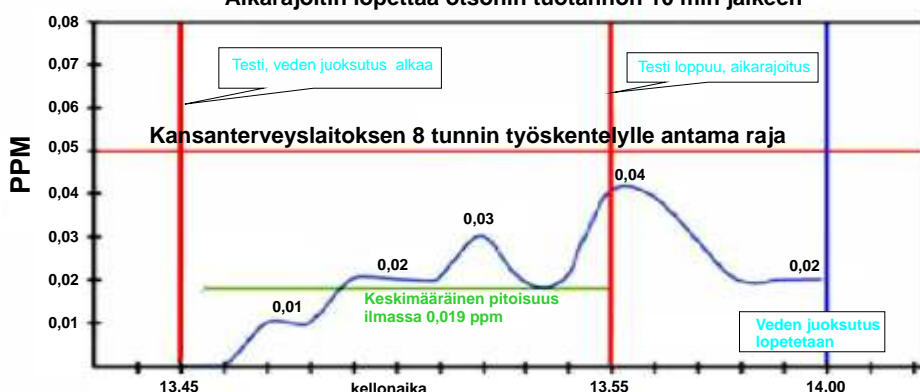
CASHIDOn tuottama ilman otsonipitoisuus 3x4 metrin tuulettamattomassa huoneessa. Aikarajoitin lopettaa otsonin tuotannon 10 min jälkeen
